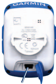
Porta mini-USB sotto il cappuccio protettivo
