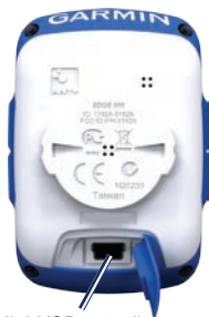
Porta Mini-USB sotto il cappuccio protettivo
