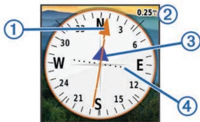
L'indicatore di percorso ① indica la posizione in relazione a una linea di percorso che conduce alla destinazione. L'indicatore di deviazione (CDI) ② fornisce l'indicazione di deviazione (destra o sinistra) dal percorso. La scala ③ si riferisce alla distanza tra i punti ④ sull'indicatore di deviazione, che indica la distanza dal percorso.
