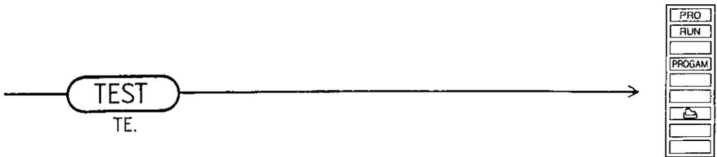
WIRKUNG : TEST prüft, ob alle vier Druckstifte funktions-
